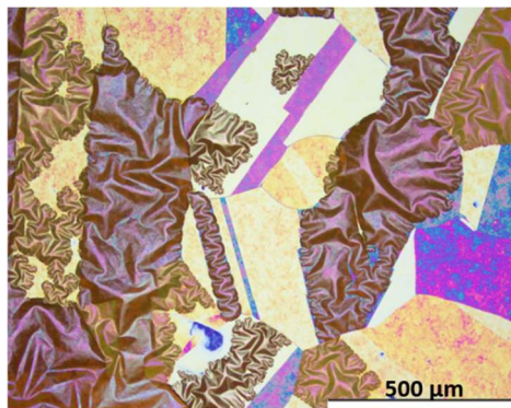
Figure 1. Cloquage sous forme de "cordons de téléphone" d'une couche d'oxyde de cuivre sous l'effet de contraintes internes en compression
