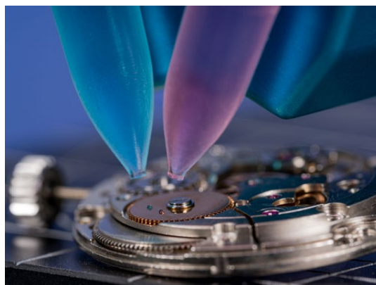
Dépôt contrôlé de gouttes nanolitriques
